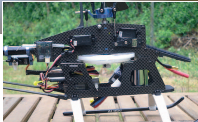
Das Chassis des T-Rex 450 besteht aus edlem CFK. Das ist leicht und steif, bricht aber bei ungewollten Landungen gerne
