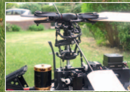
Der Rotorkopf des Mini-Titans besteht zwar aus Kunststoff, trägt jedoch zum etwas leichteren Gesamtgewicht bei
