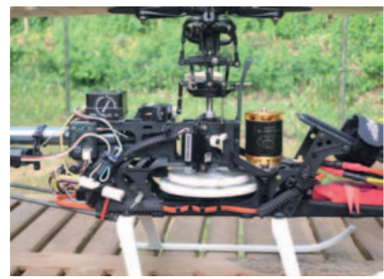
Das Chassis des Mini Titan besteht aus Kunststoff. Das ist im Grunde kein Nachteil, steckt das zähe Material doch mehr weg, als sprödes CFK. Zudem wurde der doch recht heiß laufende Originalmotor durch einen Scorpion HK 2221-8 ausgetauscht
