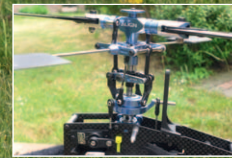
Aluminium wohin das Auge blickt. Beim T-Rex 450 ist alles leichtgängig und spielfrei
