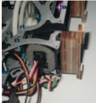
Um die KDS-Mechanik in der korrekten Höhe im Rumpf zu platzieren, mussten entsprechende Adapterklötze hergestellt und an der Lagerleiste des Chassis verschraubt werden
