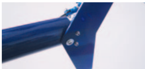
Die vordere der drei Schrauben greift in die Kiefernleisten-Verstärkung und arretiert das T-Leitwerk
