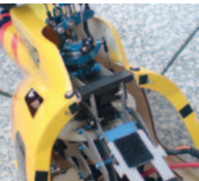
Die im Text beschriebene Zusatz-Versteifung im oberen Mechanik-Bereich
