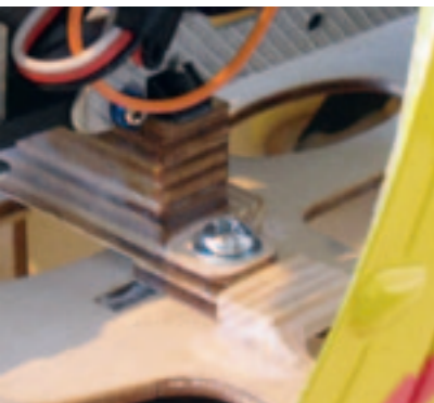
So erfolgt an allen vier Punkten die Verschraubung mit der Bodenplatte
