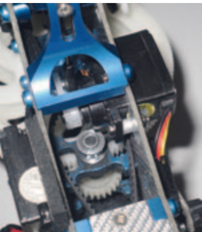
Das mit Hilfe von Alu-Buchsen nach innen versetzte Nickservo
