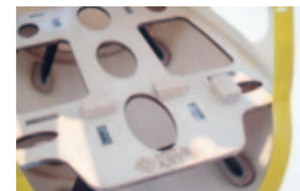
Zusätzliche, auf der Bodenplatte verklebte Klötzchen helfen bei der reproduzierbaren Positionierung der Mechanik
