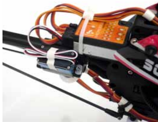
Die drei Einstellpotis des microbeast sind gut zugänglich. Das Heckrotorservo FS61 BB Carbon-Digital ließ sich problemlos am Heckservohalter verschrauben
