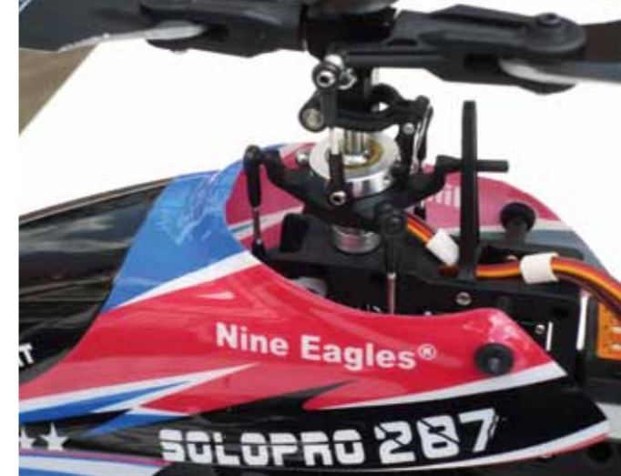
Der komplette Rotormast samt mechanischer Einstellung wurde serienmäßig übernommen
