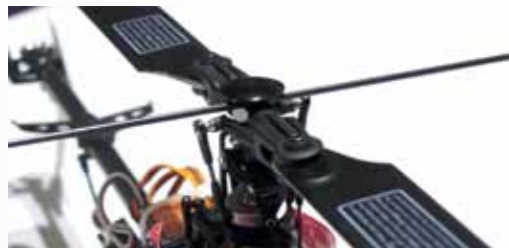
Die im Text erwähnte Stange, die am Rotorkopt-Zentralstück unter dem Bremsteller als Hilfsebene zum Justieren des Einstellwinkels fixiert wurde
