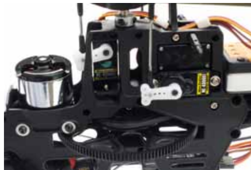
Die serienmäßigen Standard-Taumelscheibenservos harmonisieren sehr gut mit dem microbeast. Der Futaba-Empfänger, der über S-Bus-Signal mit dem microbeast verbunden ist, wurde unten zwischen den Seitenteilen platziert
