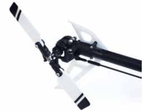
Der einfach konstruierte, spielarme Heckrotor sorgt für zufriedenstellende Heck-Performance
